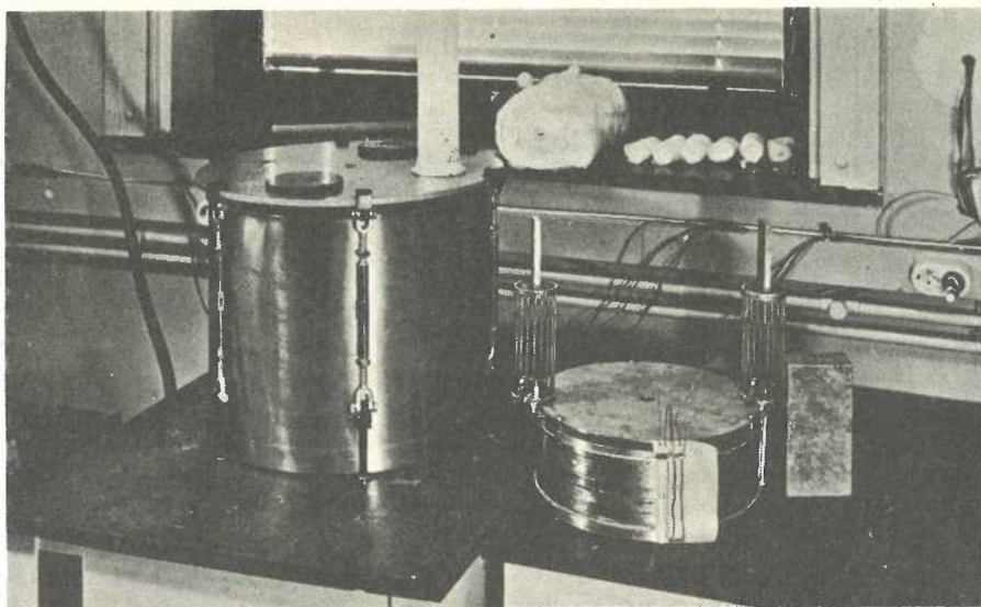
Afbeelding van de magneetspoel met links de stalen tank die als omhulling tegen explosie dient en die een binnentank bevat voor koeling met vloeibare stikstof.
